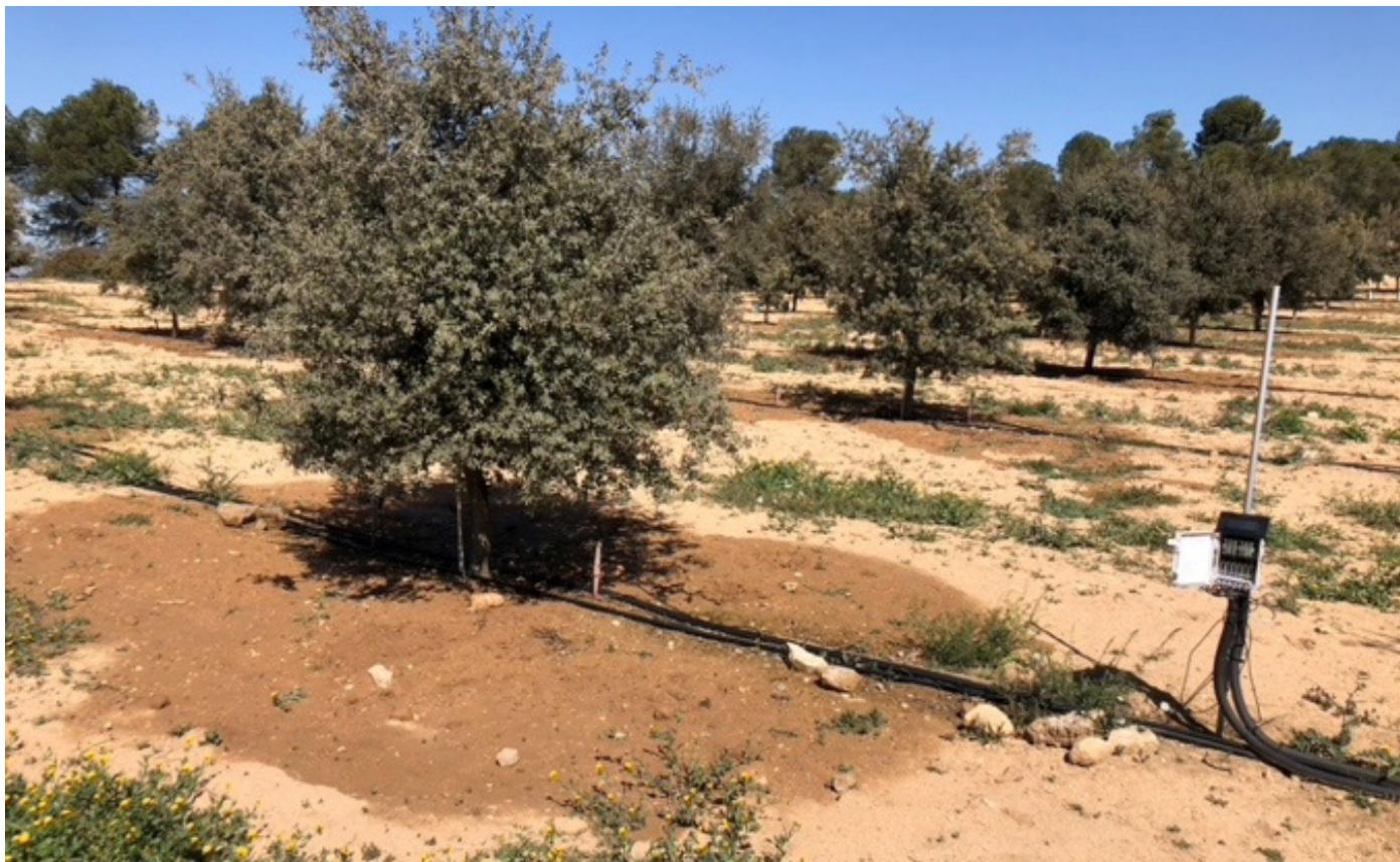
Foto 1. Tratamientos de riego en la parcela experimental del Living Lab de trufa en Cataluña (ubicada en Maials, Lleida) para el cultivo de T. melanosporum , instrumentalizada con sensores de humedad.
